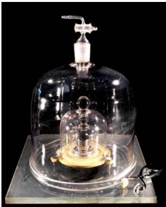
SI 基本単位の定義に用いられている唯一の人工物である国際キログラム原器 \kappa
