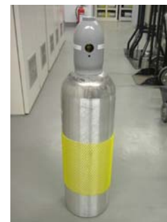
校正用標準ガス 4本 (産総研で調製)
