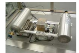
高精度特殊自動天秤 (Max=15kg, d=1mg)
